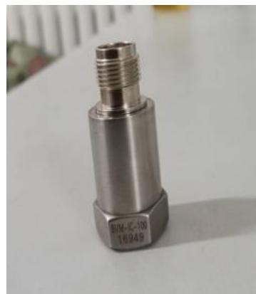
BVM-IC-100 压电加速度传感器按照 CTC102 进行设计制造，完全可以替代电荷式加速度传感器使用。无活动部件， $\pm 4\%$ 灵敏度的误差，可用于工业监控，抗干扰能力强，并且内置 IEPE 芯片，国际通用，100、500mV/g,为工业通用。
